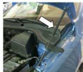
4. Прокачать амортизатор (упереть в твердую поверхность, несколько раз полностью скать и отпустить).
