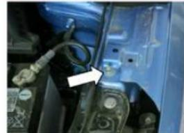
2. Установить болт-шарнир с шайбой на крыло как показано на рисунке. Затянуть болт ключом №10 с усилием 9 Нм.
